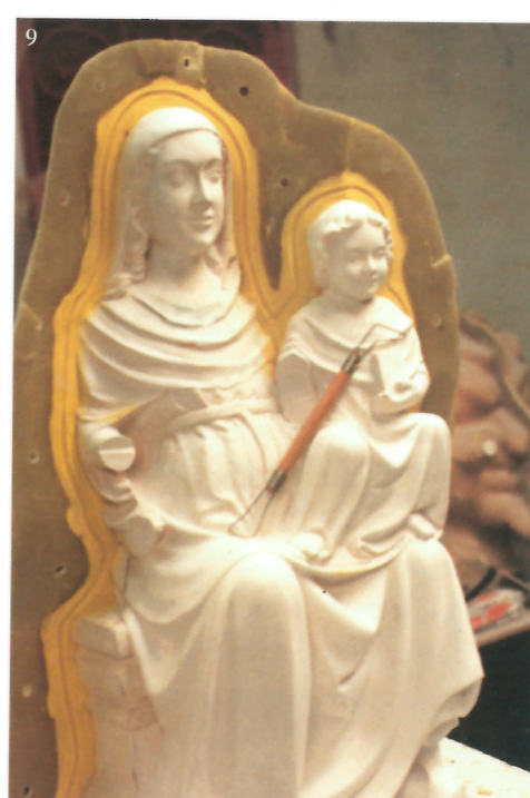
9. Imagen en la que se aprecia la junta de separación de la plastelina, con canaladura de ajuste y la caja de soporte (poliéster reforzado con fibra de vidrio) de la parte posterior
