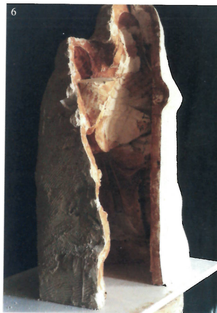
6. Molde de escayola realizado sobre el modelado con los fragmentos, con el fin de obtener una reproducción en escayola
