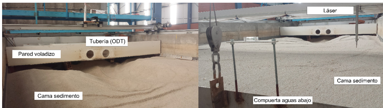
Figura 2 | Montaje experimental: Zona de erosión a analizar.
