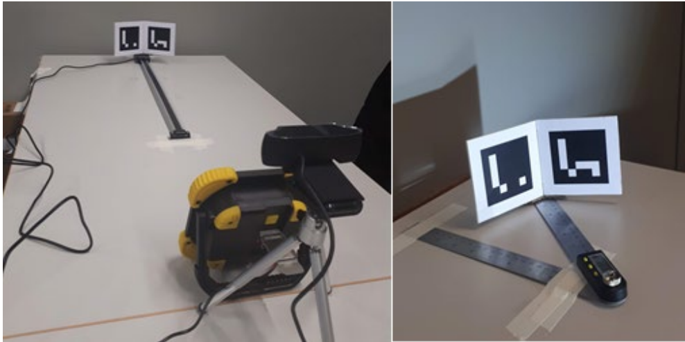
Fig. 1. Montajes para el análisis de los errores en los desplazamientos lineales y angulares estáticos
