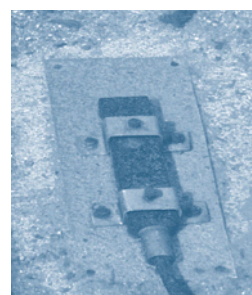
Figura 5. Probeta con los sensores y cable de conexión con el data-loggers
