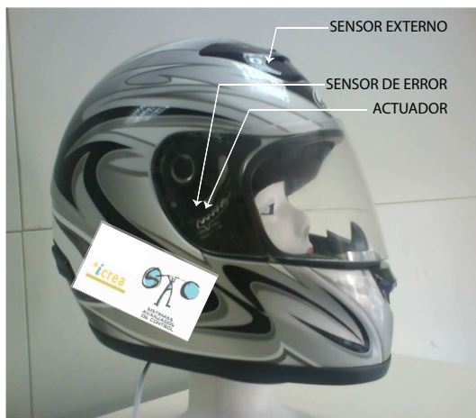
Figura 1. Colocación de los sensores y el actuador sobre el sistema físico
