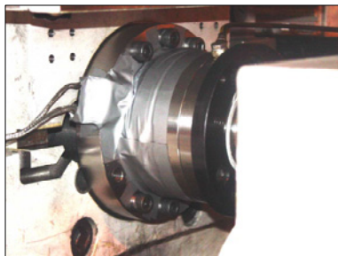
Figura 6. Actuador piezoeléctrico embebido en la rectificadora.
