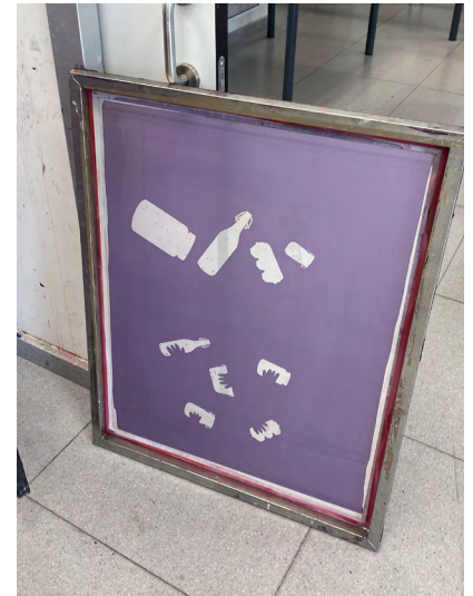
Figura 41. 3. Pantalla insolada, preparada per estampar.
