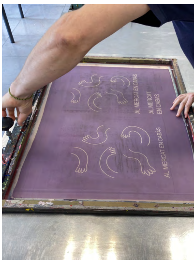
Figura 42. 4. Pantalla ajustada a les visagres i a la taula d'estampació.
