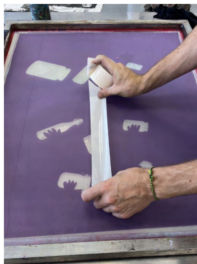
Figura 43. 5. Reserva amb precinte de les zones que no es desitgen estampar.
