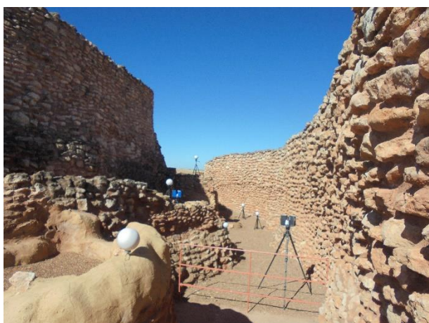
Figura 4: Labores de escaneado digital en el interior del monumento.
