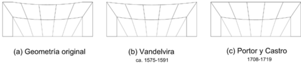
Figura 10. Alzado del «capialzado a regla»: a) forma geométrica intacta después de la intersección de un plano inclinado con un cilindro vertical; b) corrección de la forma del extradós en los extremos (Vandelvira ca. 1575-1591, fol. 45v.); c) corrección del extradós para facilitar la vinculación con el paramento vertical donde se coloca (Portor y Castro 1708-1719, fol. 41r, 45r. [nº lápiz]).
