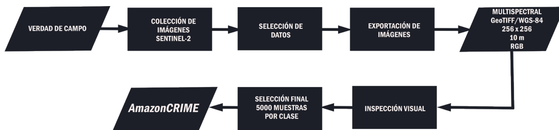
Figura 1. Flujo de trabajo del método semiautomático para seleccionar y exportar los recortes de imágenes mediante GEE.
