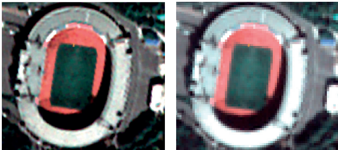
Figura 6. Análisis visual comparativo entre Corea_Bundle MS4-L1D (izquierda) y Corea_Bundle MS4-L1C (derecha). El desplazamiento espacial entre los dos productos es de 1,8 metros Escala: 1:2000.
