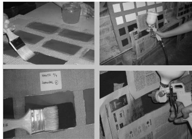
Figura 3. En la parte superior la imagen muestra la aplicación del barniz de resina natural aplicado a brocha y pistola de aspersión. En la imagen inferior se muestra la aplicación del barniz de resina sintética
