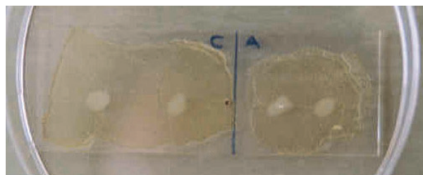
Figura 2. Resina almáciga sobre soporte vidrio inoculada con microorganismos
