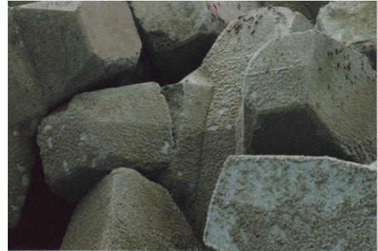
Figura 2 | Asentamiento y rotura de elementos Accropode® de 6.3 m 3 y 9 m 3 ante eventos de diseño.
