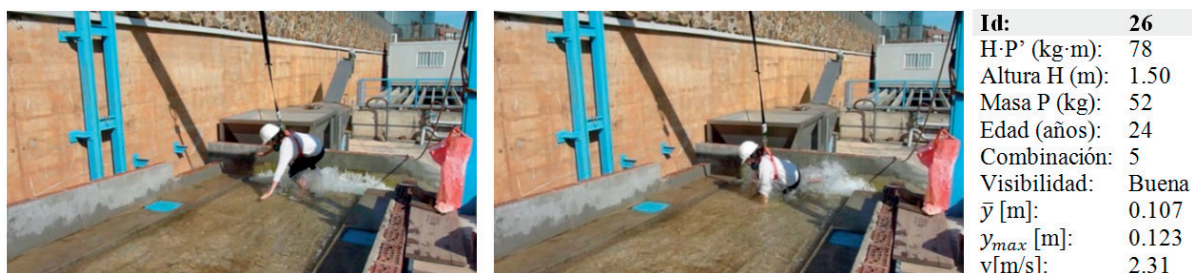
Figura 9 | Ejemplo de pérdida de estabilidad para un ensayo con manos libres y buena visibilidad.
