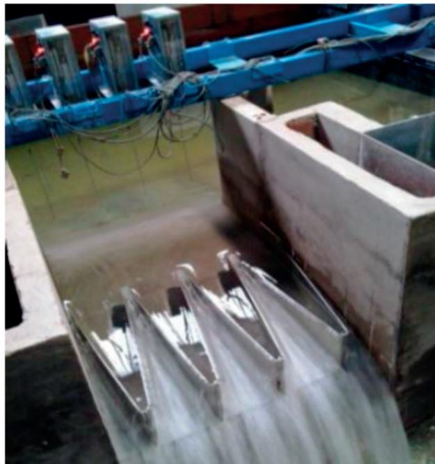
**Figura 4 |** Detalle de ensayo físico con alimentación frontal y aproximación en canal de la primera campaña de ensayos del proyecto POLILAB.
