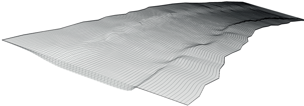
Figura 4 | Malla de cálculo del dominio de estudio del río Tercero aguas abajo del puente Juan Bautista Alberdi en la ciudad de Villa María.
