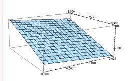
b) A continuación, realizamos la representación de la superficie sobre la que se diseña la carretera; en este caso, supondremos que es una gaussiana simétrica en dos variables.
