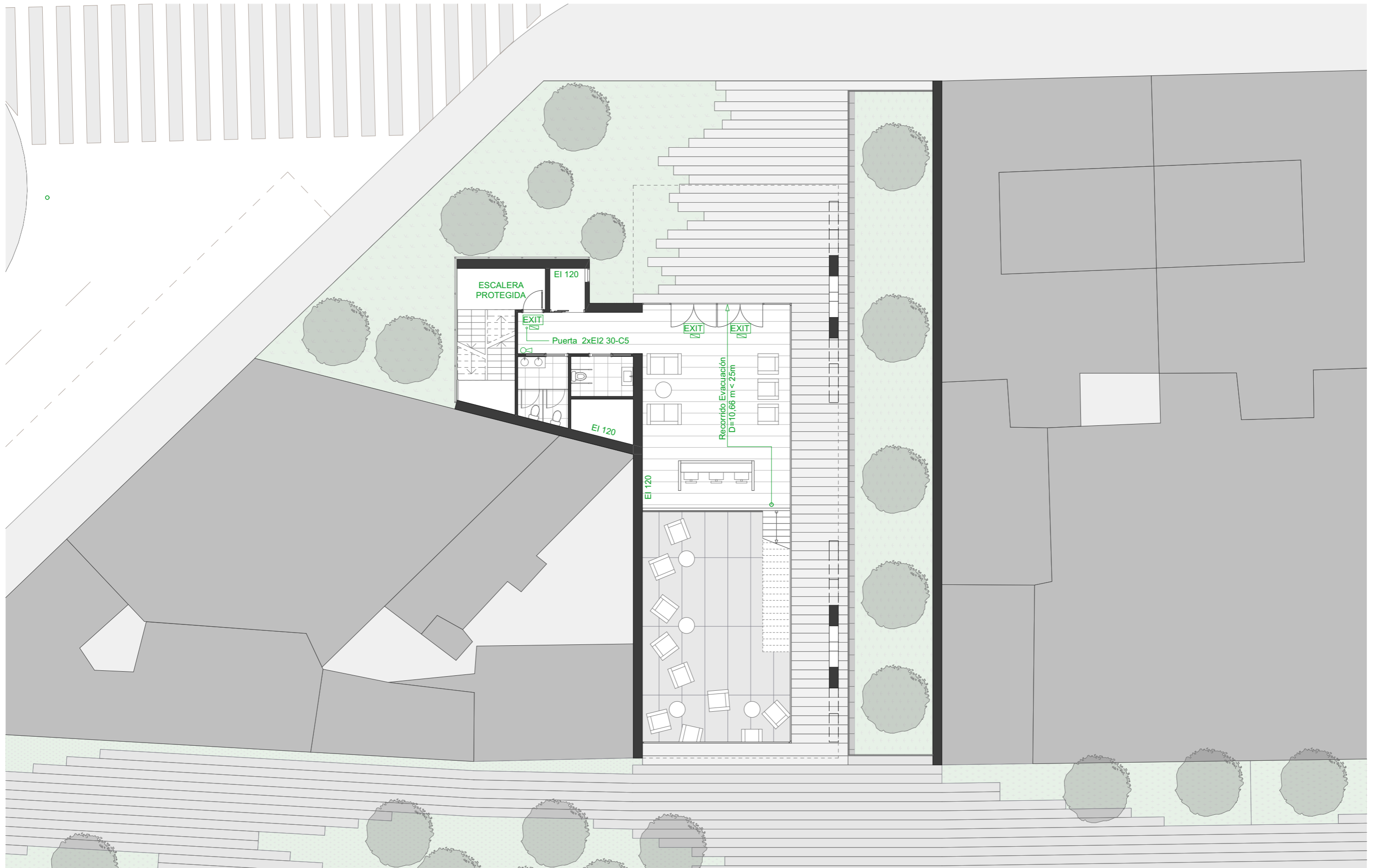
CUMPLIMIENTO DB-SI PLANTA BAJA cota 0,00 m
