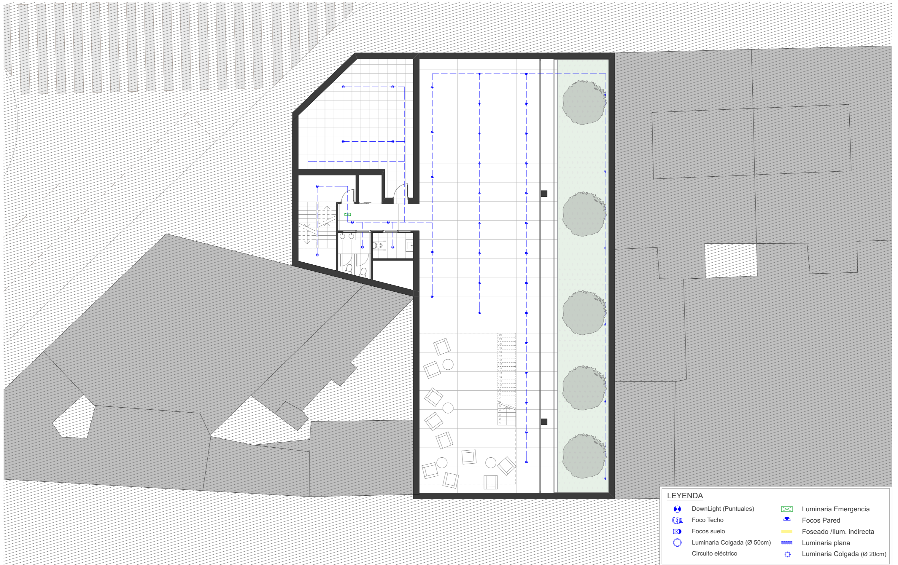
INSTALACIÓN ELÉCTRICA SÓTANO 1 cota -4,00 m
