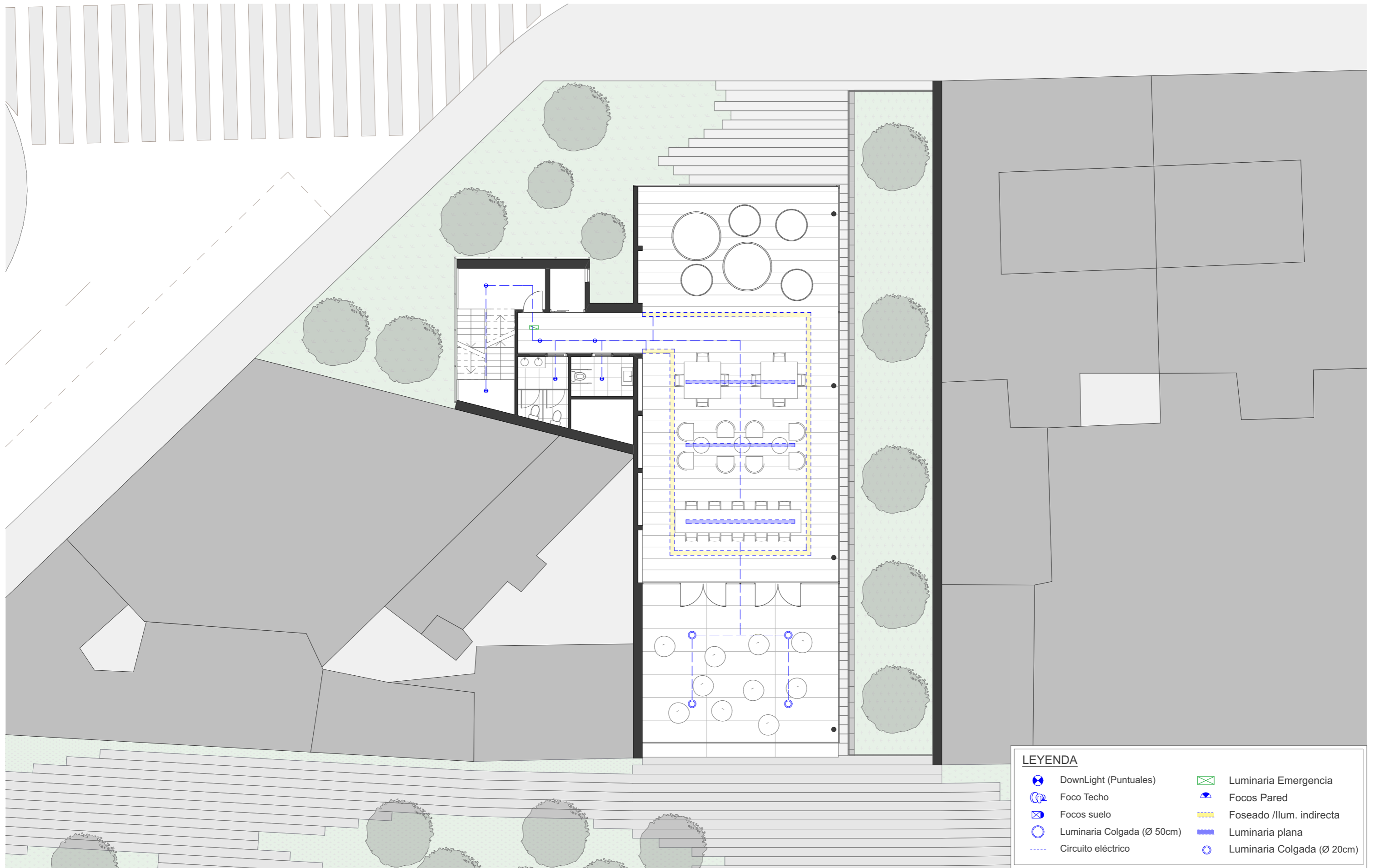
INSTALACIÓN ELÉCTRICA PLANTA PRIMERA cota 4,00 m
