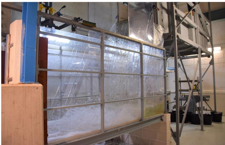
**Figura 4 |** Infraestructura para el estudio de chorros en aliviaderos de vertido libre (caso  $q=0.031 \text{ m}^2/\text{s}$ ,  $H=2.23 \text{ m}$ ,  $Y=0.02 \text{ m}$ ).
