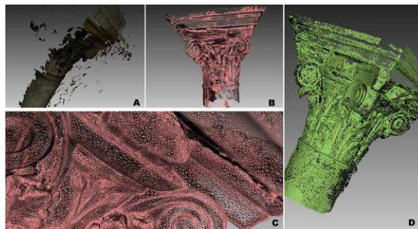
Figura 13. A) Ruido producido durante uno de los escaneos; B) Nube de puntos obtenida; C) Proceso TIN; D) Resultado de la superposición de los distintos escaneos. 2012. Fuente: Autores
