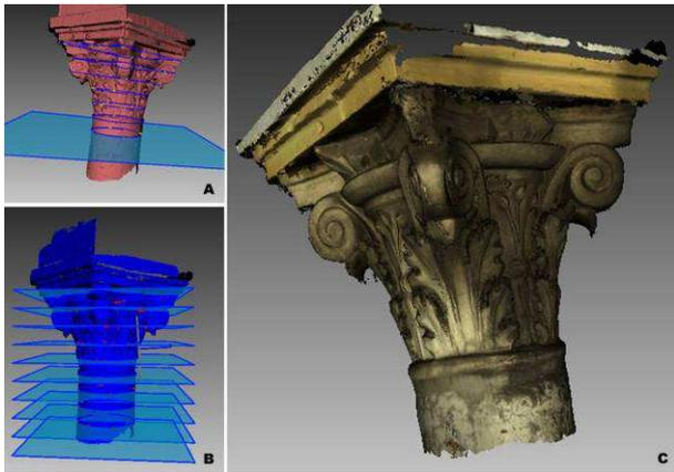
Figura 6. A y B) Planos de sección a el cuerpo del capitel; C) Modelo 3D texturizado. 2012. Fuente: Autores
