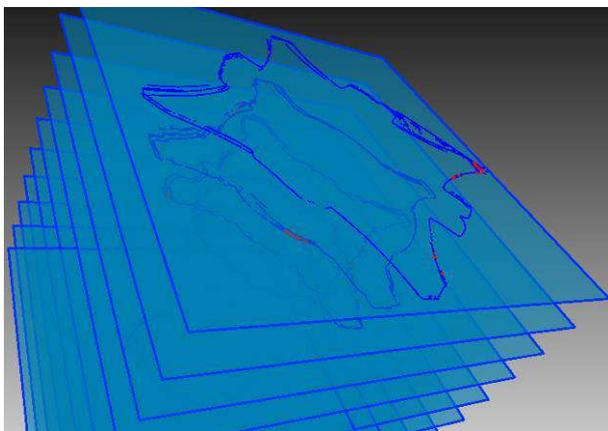
Figura 7. Secciones del capitel a distintas cotas obtenidas a partir del modelo 3D. 2012. Fuente: Autores.
