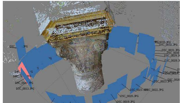
Figura 9. Proceso de alineación y nubes de puntos obtenidas. Fuente: Autores
