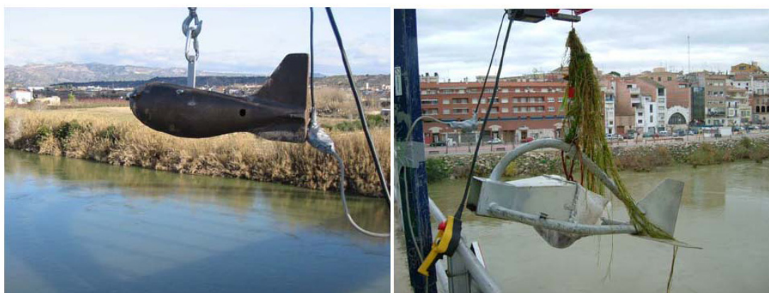
Figura 2. Muestreadores de transporte de sedimentos: Izq.: US DH74 para muestras integradas de sedimento en suspensión; Drch.: Helley-Smith de 76 mm para carga de fondo (Fotos: RJ Batalla)
