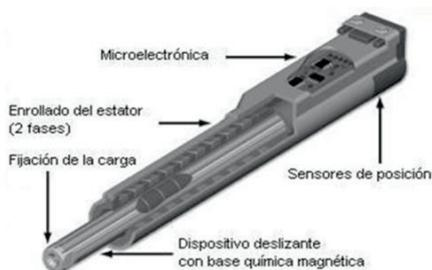
Figura 4b: Esquema del motor lineal.
