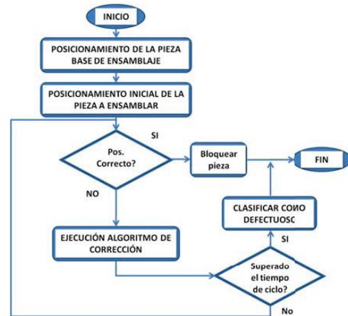
Figura 6: Diagrama de flujo del proceso de ensamblaje.
