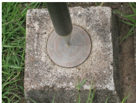
Fig. 2. Señal perteneciente al vértice del Observatorio construida en la campaña Geodésica de EEUU del año 1994.
