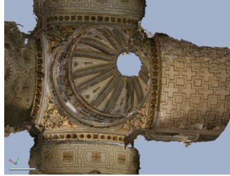
Fig. 2: Perspectiva del modelo triangulado de la zona interior de la cúpula de la Iglesia S. Justo y Pastor (Granada), realizada mediante fotogrametría multi-imagen. Fuente: José Antonio Benavides
