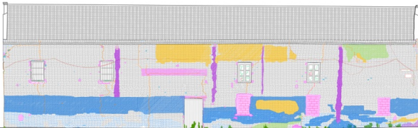
Fig 5. Metodología de representación de las patologías existentes en la fachada oeste de la Fábrica del Hielo. 2012. Fuente: elaboración propia
