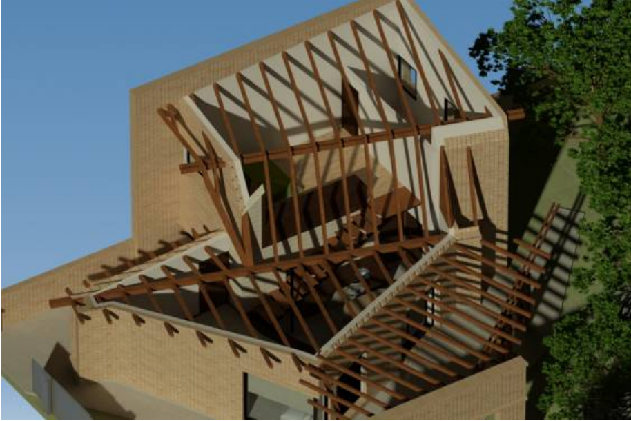
Fig 3. Casa Cuello (Arzubialde y asociados). Vista Axonométrica de el sistema estructural de la cubierta. Imagen de Francisco Torres Rico, alumno de EGA3. ETSAG (Curso 2011-2012)
