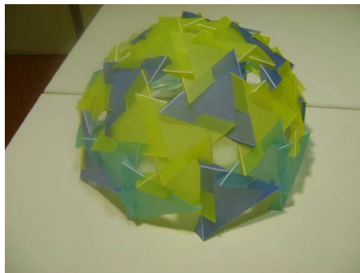
Fig. 9. El modelo corresponde a una geodésica de Frecuencia 2 y se compone de 80 módulos, 20 de un tipo más 60 de otro.
