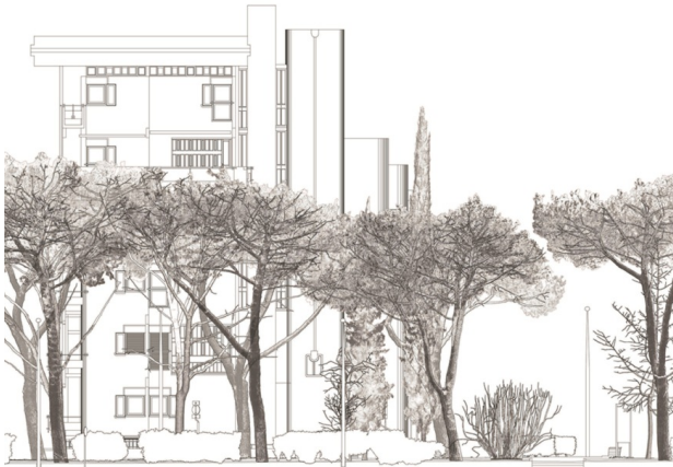
Fig 2. Sezione prospettica di una porzione di viabilità urbana nella quale sono presenti alberature e trattamenti a verde. Il disegno, per poter essere affidabile e riproporre metricamente la complessità delle Unità Vegetali presenti, richiede numerose interazioni tra diversi strumenti di lettura del luogo. L'utilizzo di sistemi laser scanner e per verificare, tramite le nuvole di punti, la morfologia ed il carattere del verde, il rilievo degli elevati degli edifici, l'esigenza di avere una planimetria per gestire gli scorci, la scelta delle diverse soluzioni grafiche per il trattamento dei materiali, sono aspetti di progetto che inquadrano il disegno all'interno di un preciso sistema descrittivo.
