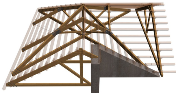
Fig 6. Levantamiento del encuentro de esquina. 2010. García-Asensio-Medina.
