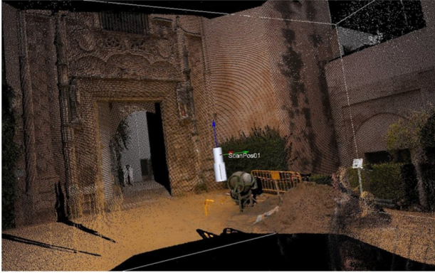
Fig 5. Nube de puntos capturada por el escáner láser con información RGB de cada punto. Reales Alcázares (Sevilla). Elaboración propia
