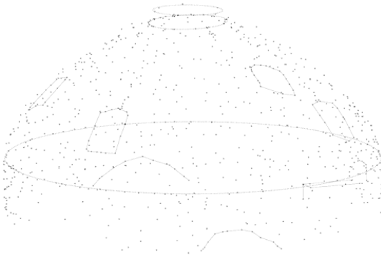
Fig 5. Vista del modelo tridimensional de puntos obtenido mediante fotogrametría. Aliberti, L., Alonso, M. A., Canciani, M.
