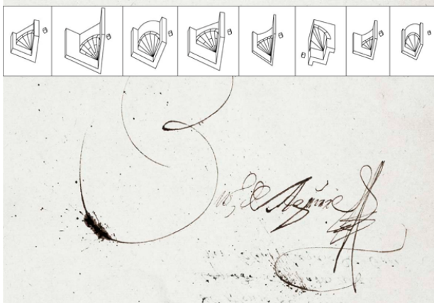
Fig.1. Modelo tridimensional de las ocho trompas contenidas en el manuscrito sobre la firma de Juan de Aguirre: Carpanel. Medio punto. Torre redonda. En viaje despiezada. Torre cavada. En esquina. Torre redonda de Montpellier. Torre Cavada.2012. Elaboración propia- manuscrito MSS 12744.
