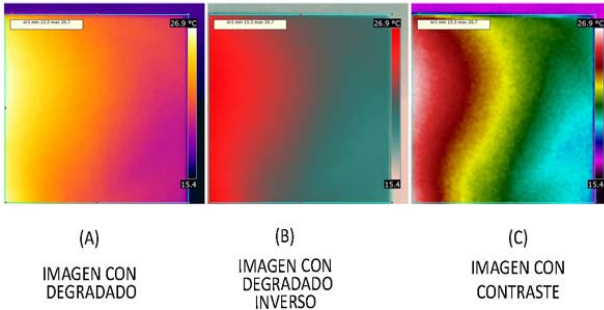
Fig. 8. Imagen derecha, que refleja la zona humedecida. En cada una de las imágenes se ve la misma temperatura pero con diferentes gama de colores.
