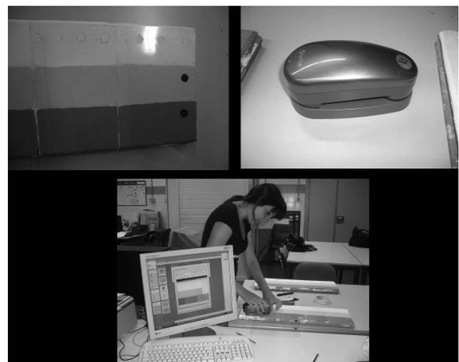
Figura 6. Para llevar a cabo las mediciones colorimétricas, se ha usado un sistema de medida utilizada frecuentemente en el campo de la conservación y restauración conocido como barrido cromático, que consiste en la medición de puntos clave seleccionados. El siguiente paso, fue seleccionar los puntos-muestra, es decir las zonas de las probetas en donde se utilizó el colorímetro Eye one Basic
