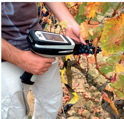
Figura 6 | Utilización de un sensor NIR portátil para la determinación en el viñedo del contenido en azúcares en la baya.
