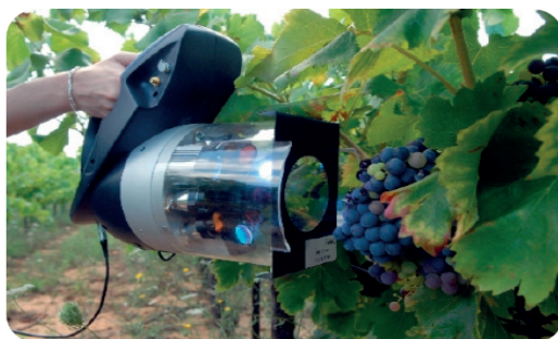
Figura 7 | Medición del contenido de antocianos en uva de forma no destructiva (sin análisis en el laboratorio) con un sensor de fluorescencia en el viñedo.
