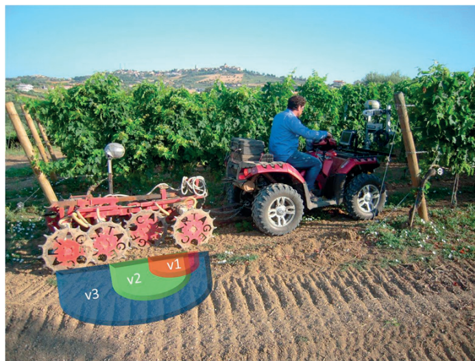
Figura 1 | Monitorización en continuo de la resistividad eléctrica aparente del suelo, con el sensor ARP, utilizado en viñedos de La Rioja y Navarra por el grupo Televitis.
