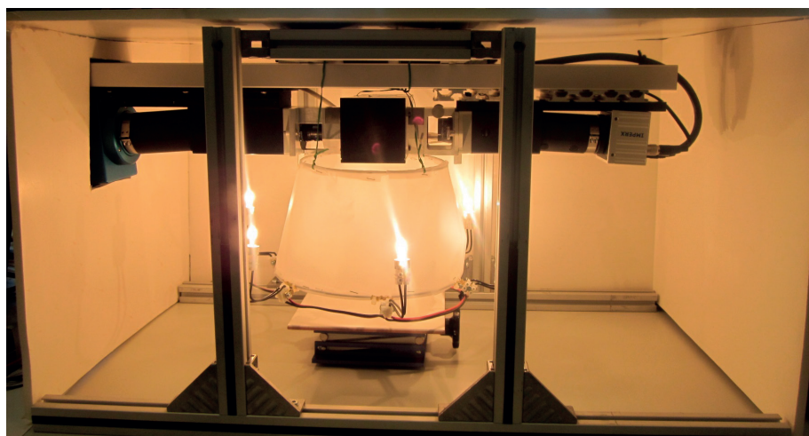
Figura 4 | Sistema de visión hiperespectral en el rango del visible e infrarrojo cercano para adquisición de imágenes en laboratorio, utilizado por el grupo Teletvis en la Universidad de La Rioja.
