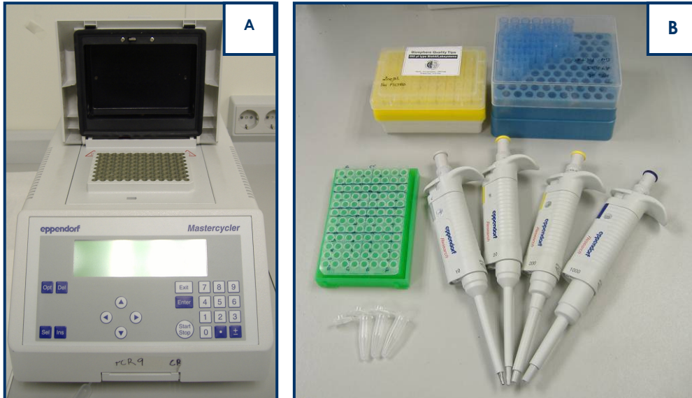
Figura 4. Equipo y materiales para llevar a cabo una PCR: A. Termociclador. B. Puntas, placa de PCR, microtubos y juego de micropipetas.
