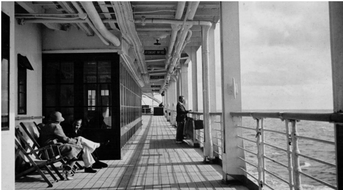
Figura 24. MUSTSEEPLACES (1920). Barandilla de perfiles tubulares.
