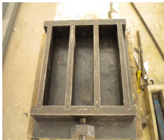
Fig 13. Molde para probetas 16x4x4 cm
