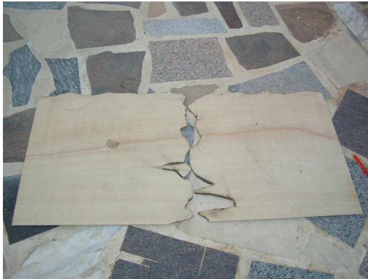
Figura 17. Contrachapado trabajado con amoladora angular.
