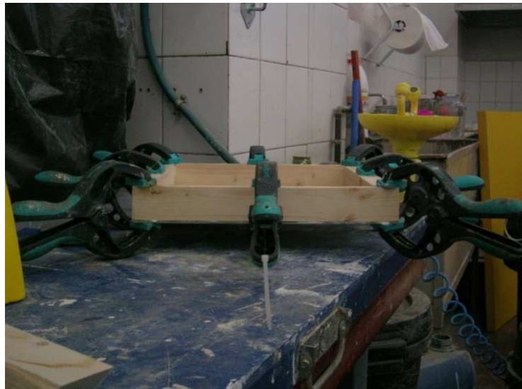
Figura 5. Montando el contrachapado sobre el bastidor.
