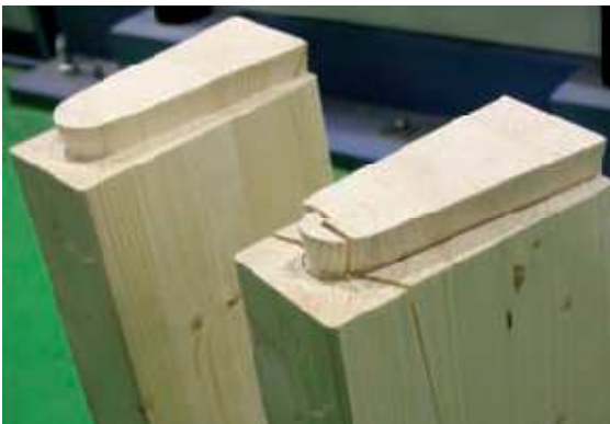
Figura 7.12. Ensamble a cortante en cola de milano (fuente: Cismadeira)
