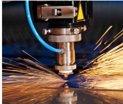
Figura 59. Corte por láser (Fuente: Sculpteo)
