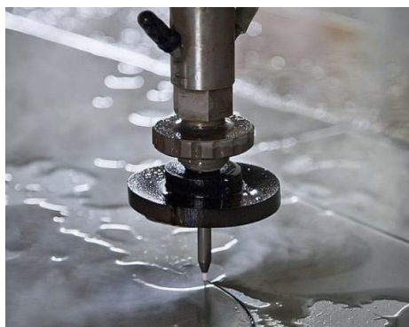
Figura 58. Corte por chorro de agua. (Fuente: Mecanizadossinc)
