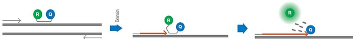
Figura 9. Proceso de quenching y activación fluorescente tras la fase de extensión de la PCR en sondas de hidrólisis TaqMan (R verde: fluoróforo reportero; Q azul: quencher ) (BIO-RAD, 2015).
