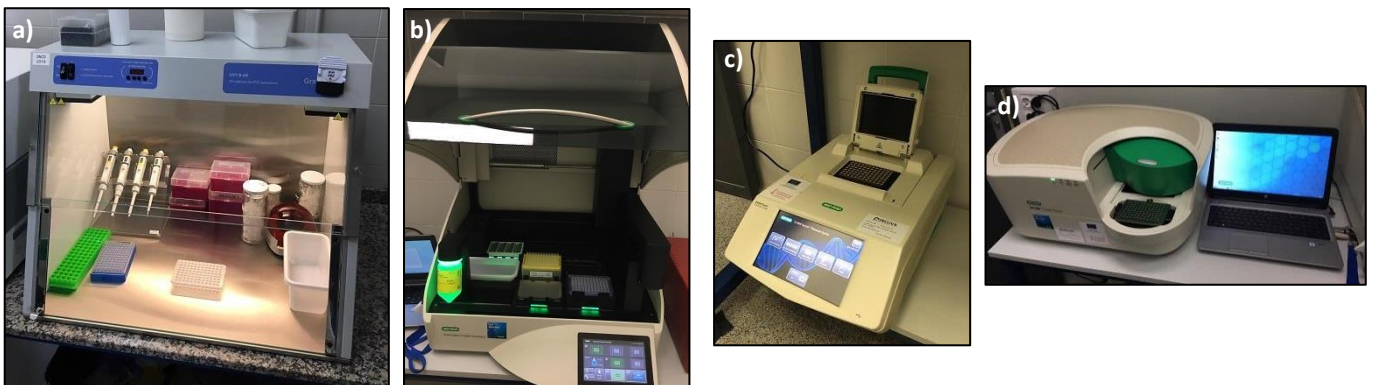
Figura 15. Equipo básico de ddPCR: cabina de configuración de placas (a), robot generador de nanogotas (b), termociclador (c) y lector de resultados (d).
