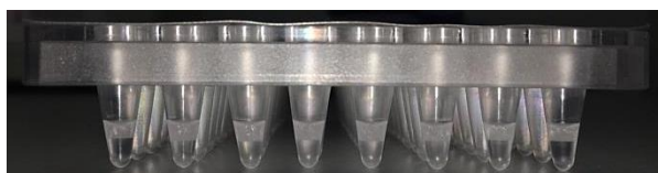
Figura 16. Emulsión de agua en aceite (interfase) generada en la placa tras la generación de nanogotas.
