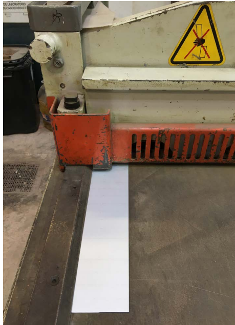
Fig. 13-14-15. Corte con la cizalla hidráulica del taller de metal del Departamento de Escultura. Planchas de aluminio de 2mm. 2018.
