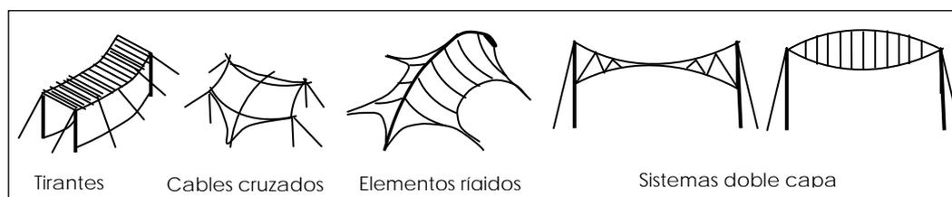
Figura 2. Sistemas de estabilización
