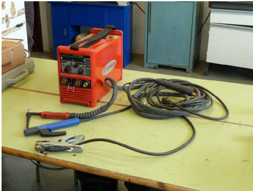
Figura 28: Equipo Transtig 1700 para soldadura eléctrica y soldadura TIG
