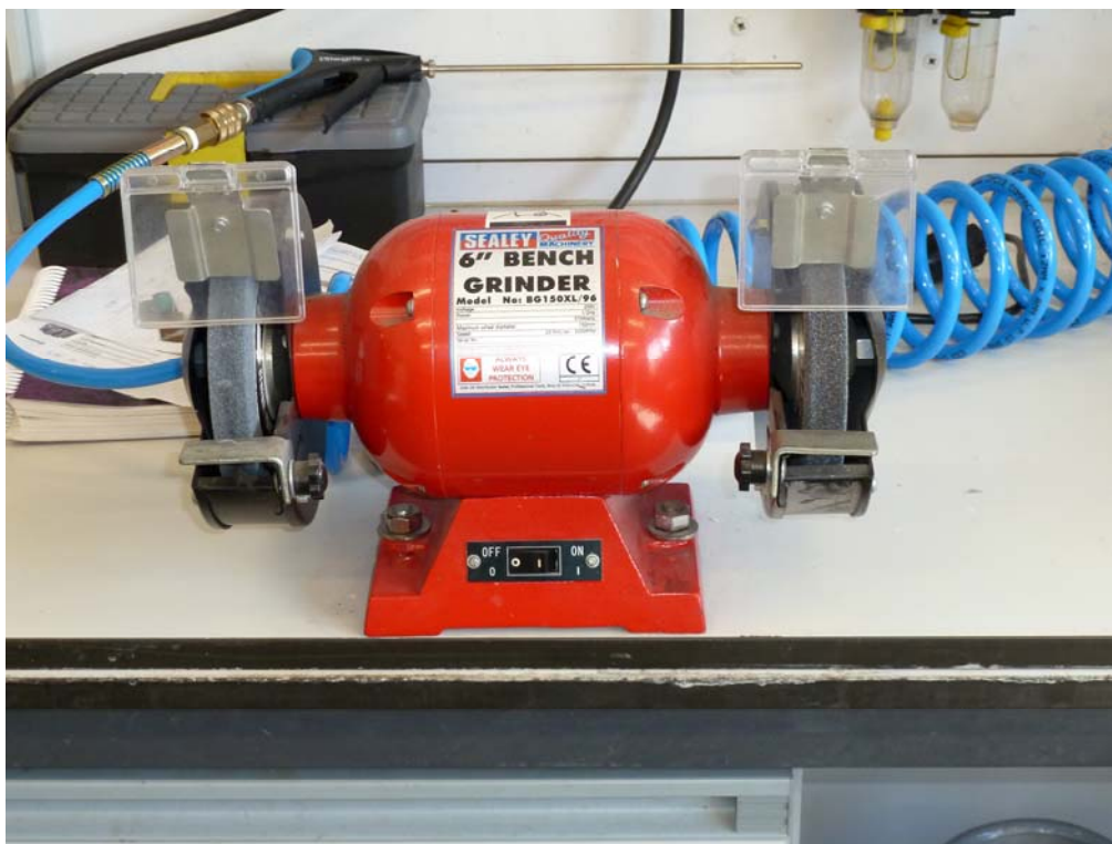
Figura 31: Esmeriladora doble de 375 vatios BG150XL/96
