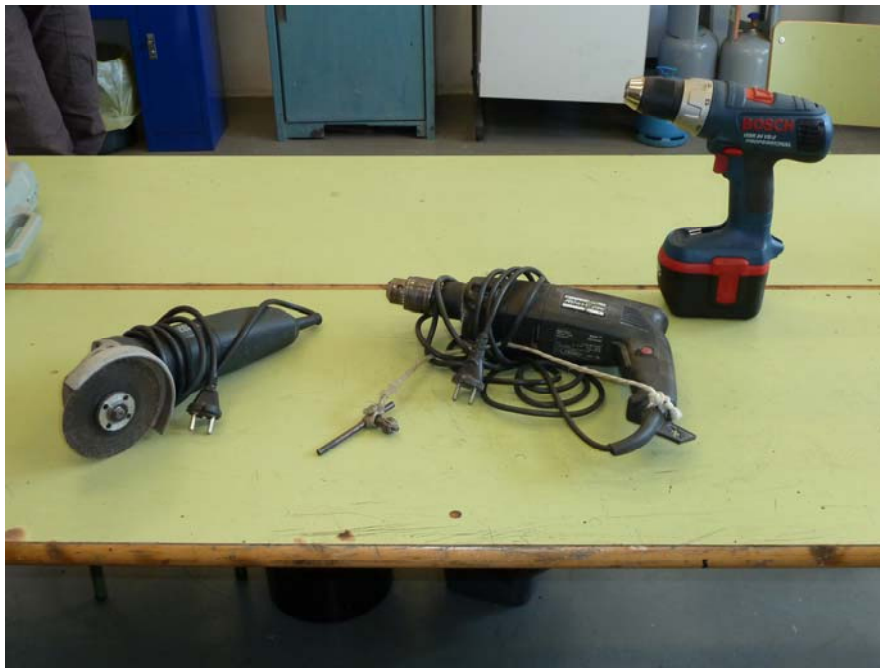
Figura 33: Taladro, atornilladora y radial
