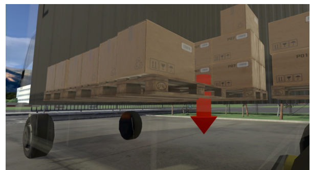
(b) centro de gravedad de la carga.
