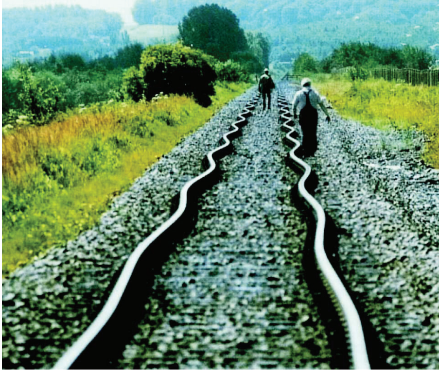
Figura 3.18. Estado de la vía tras ensayo de entrada en lazo (extraído de [88]).
