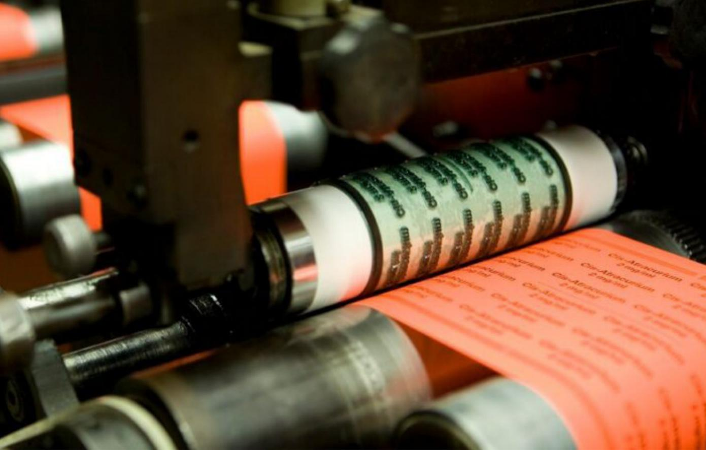
Fig. 5 Detalle de un rodillo de imprenta flexográfica que utiliza film de fotopolímero.
