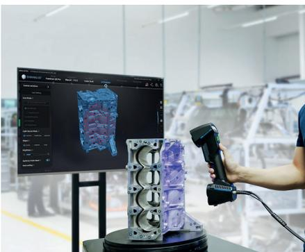
101. Escaneado manual láser. El modelo de la imagen es: ESCÁNER LASER FRE-ESCAN UE PRO DE SHINING 3D.
