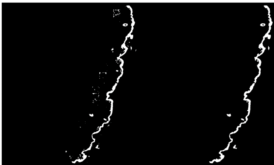
ILUSTRACIÓN 49: RESULTADO DEL POST PROCESADO DE QUITAR PEQUEÑOS OBJETOS (A LA IZQUIERDA LA IMAGEN SIN PROCESAR Y A LA DERECHA LA IMAGEN FINAL)
