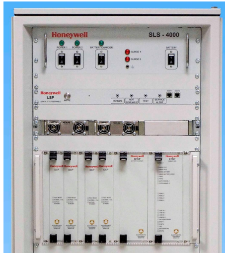
Figura 3.4: SLS-4000 de Honeywell, unidad de cómputo para GBAS [21]
