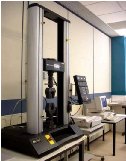
Fig. 4.2.4. y 4.2.5. Máquina de ensayos universales tipo Instron y esquema probeta de ensayo.
