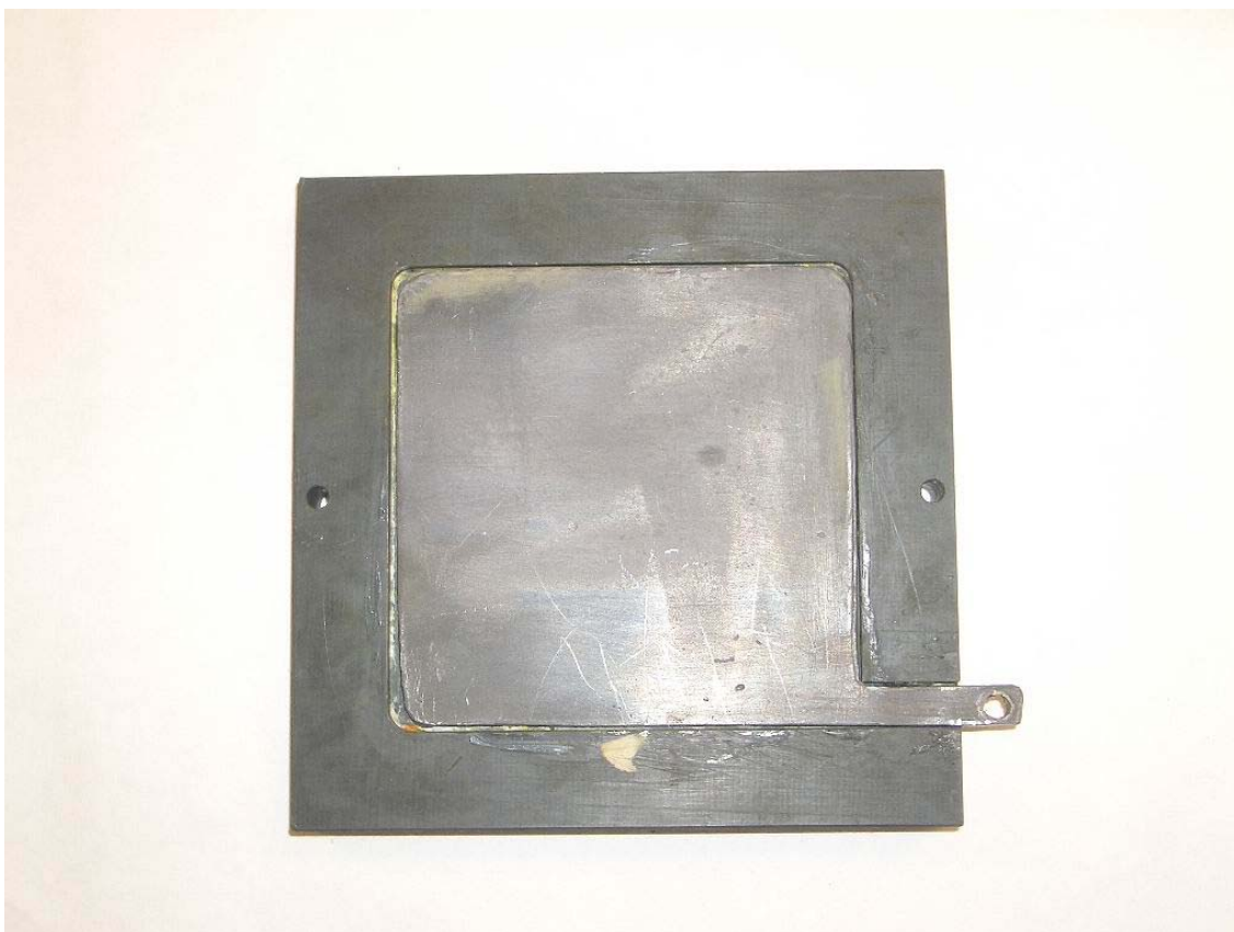
Figura V.8. Ánodo de plomo utilizado en el reactor electroquímico a escala piloto.
