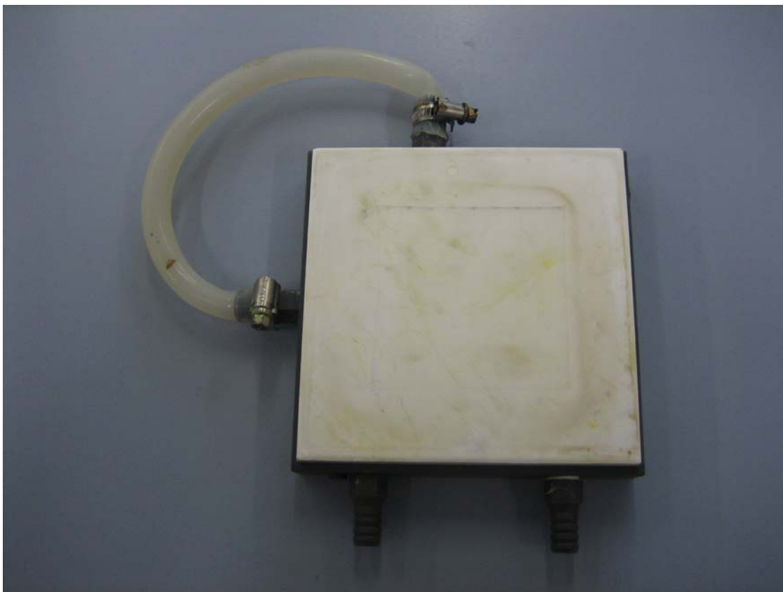
Figura V.10. Separador cerámico utilizado en el reactor electroquímico a escala piloto.
