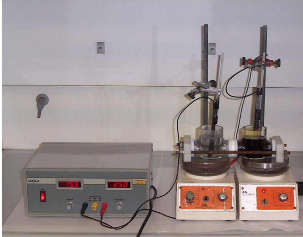
Figura IV.3 Reactor electroquímico de compartimentos separados.
