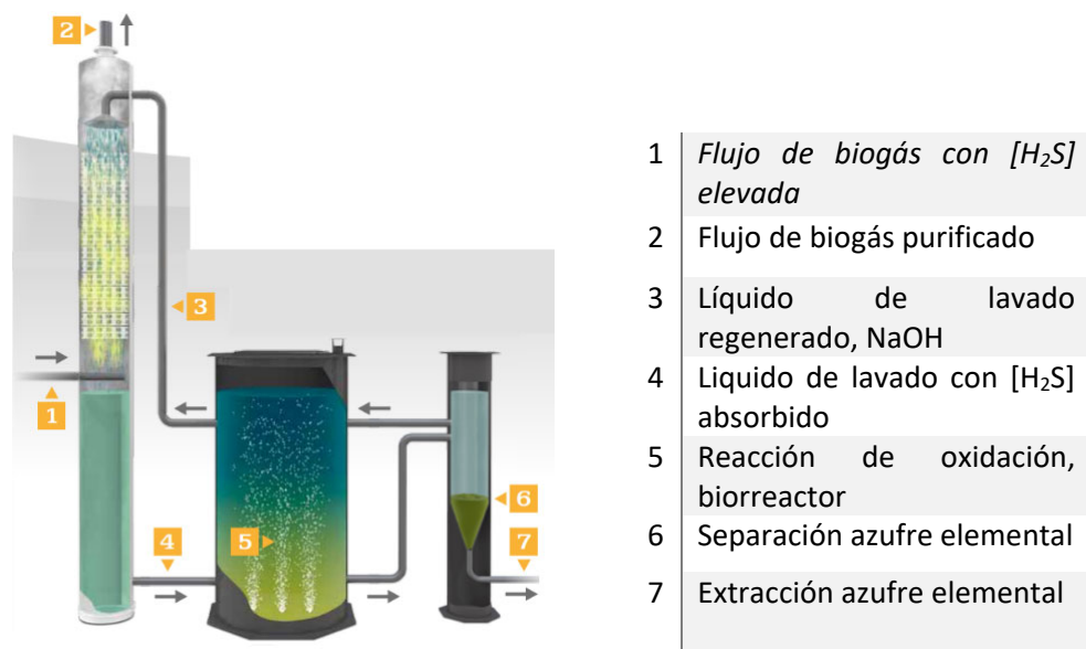
Figura 21. Equipo de eliminación de ácido sulfhídrico, por lavado químico y biológico, del biogás. Modelo THIOPAQ® (PAQUES)
