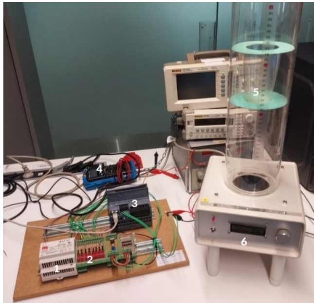
Figura 1. Sistema de levitación de aire, junto con PLC para realizar un control digital externo.
