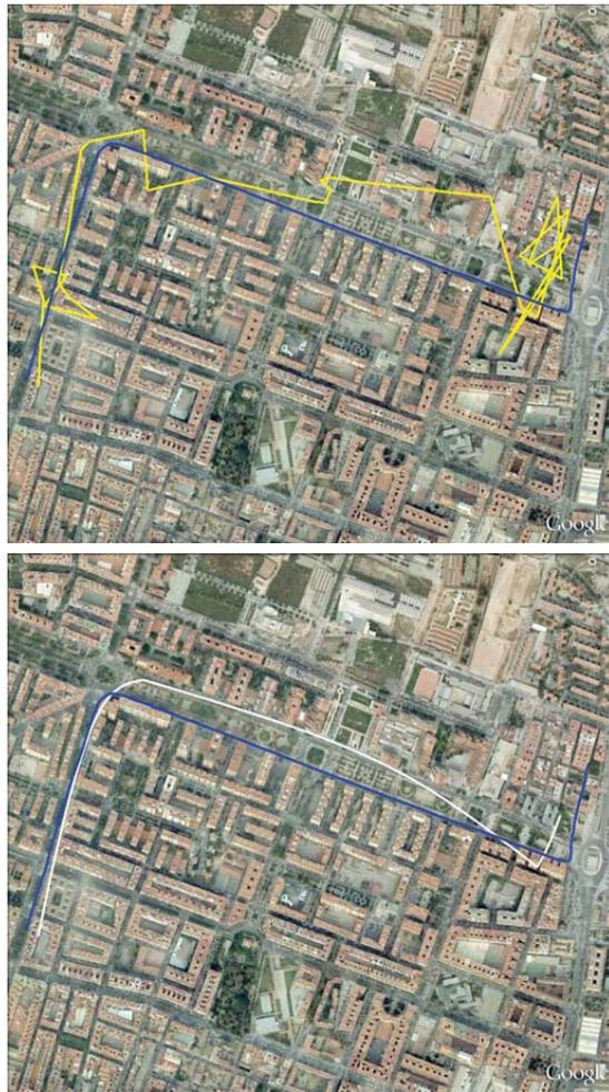
Figura 3.5: Ejemplos de salida de ALT-P, línea amarilla de la figura superior, y ALT-PS, línea blanca de la figura inferior, respecto a la ruta GPS seguida durante la llamada, línea azul en ambas figuras
