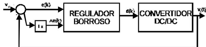
Fig. 1-9 Control borroso directo de un convertidor dc/dc.
