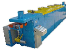
Figura 12: Hornos microondas para vulcanizado de perfiles de goma [ http://www.itaigum.com/hornoscaucho.htm ]
